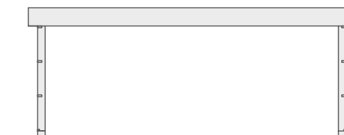
KONSTRUKCJA SŁUPOWO-RYGLOWA BELKOWA PŁASKA
