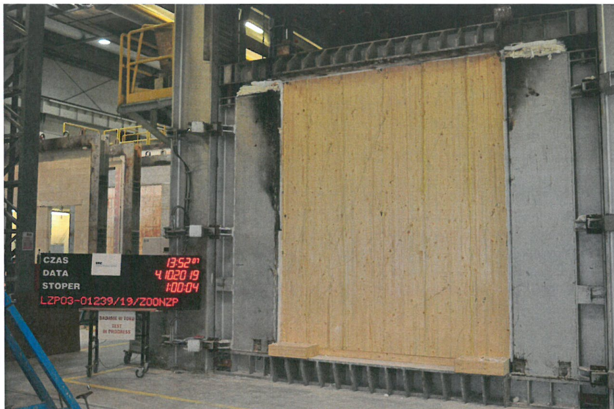
Fot. 5. LZP03-1239/19/Z00NZP Element próbny w trakcie badania (60 min)
