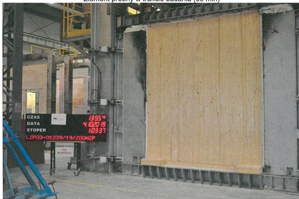
Fot. 6. LZP03-1239/19/Z00NZP Element próbny w chwili zakończenia badania (63 min)
