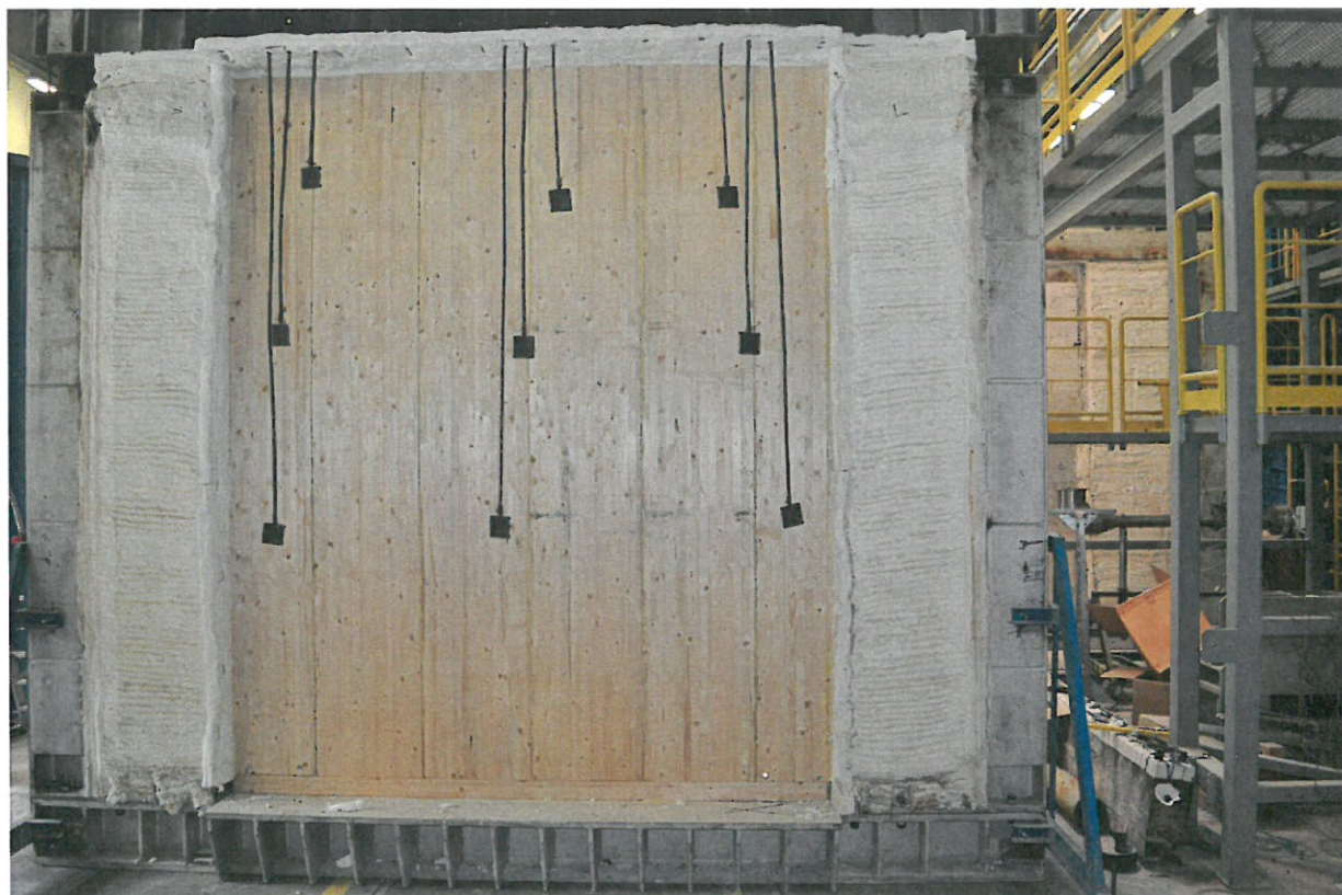
Fot. 1. LZP03-1239/19/Z00NZP Element próbny przed badaniem – widok od stony nagrzewanej
