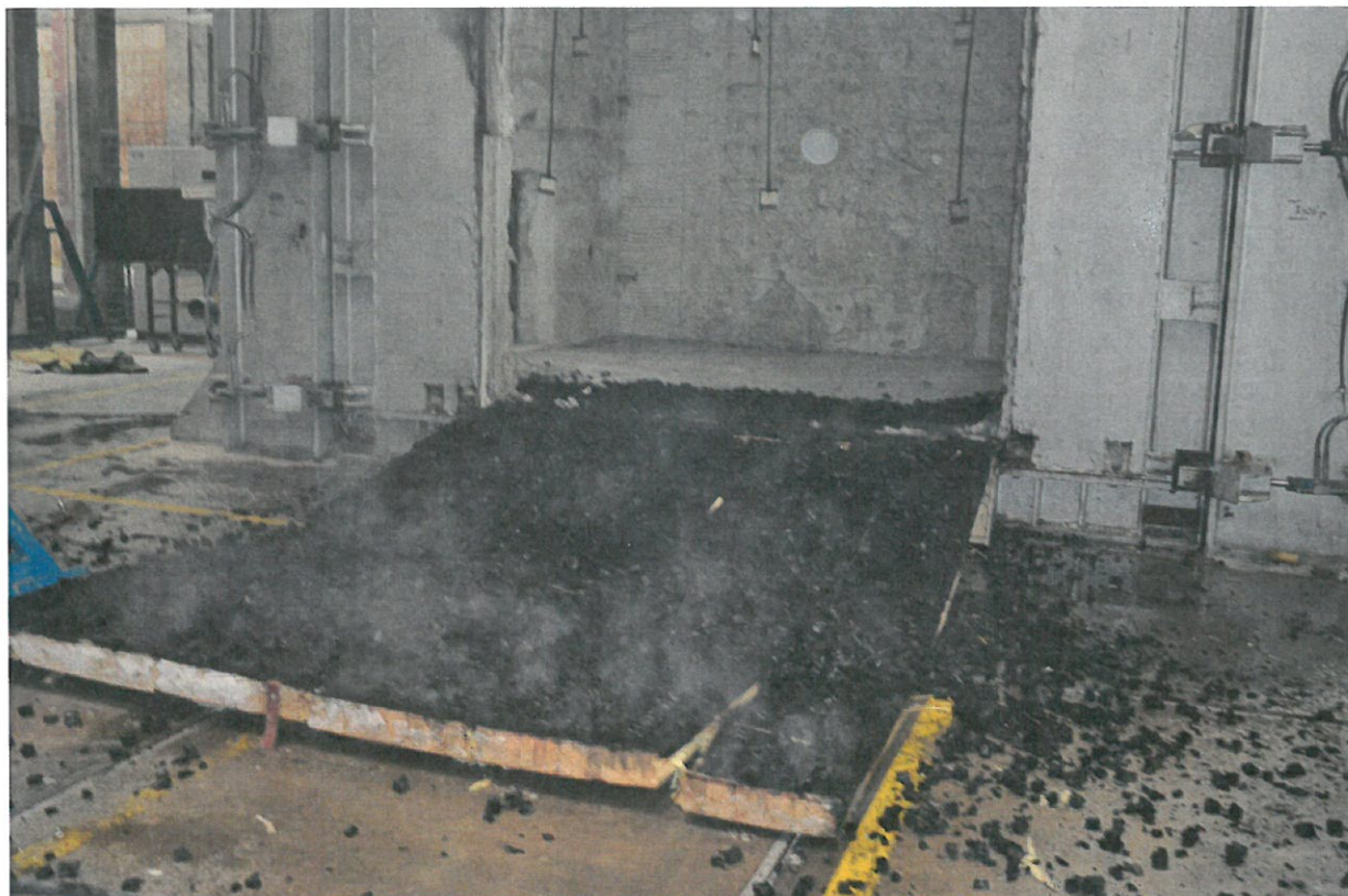
Fot. 8. LZP03-1239/19/Z00NZP Element próbny po badaniu (po ugaszeniu drewna) – widok od strony nagrzewanej
