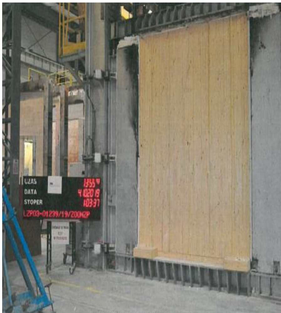
Fot. 6. LZP03-1239/19/Z00N2P Element próbny w chwili zakończenia badania (83 min)
