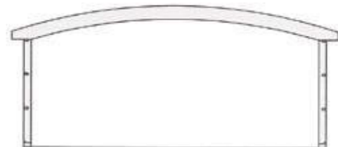
KONSTRUKCJA SŁUPOWO-RYGŁOWA ŁUKOWA
