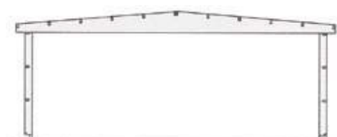
KONSTRUKCJA SŁUPOWO-RYGŁOWA TYPU DWUTRAPEZ
