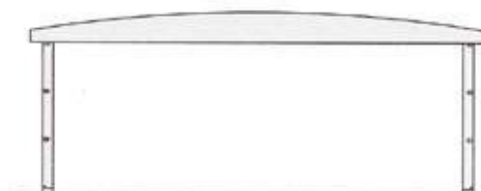
KONSTRUKCJA SŁUPOWO-RYGŁOWA TYPU DWUTRAPEZ ŁUKOWY
