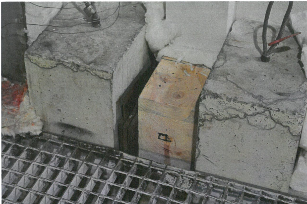
Rys. 3. Element próbny przed badaniem – zamocowanie belki
