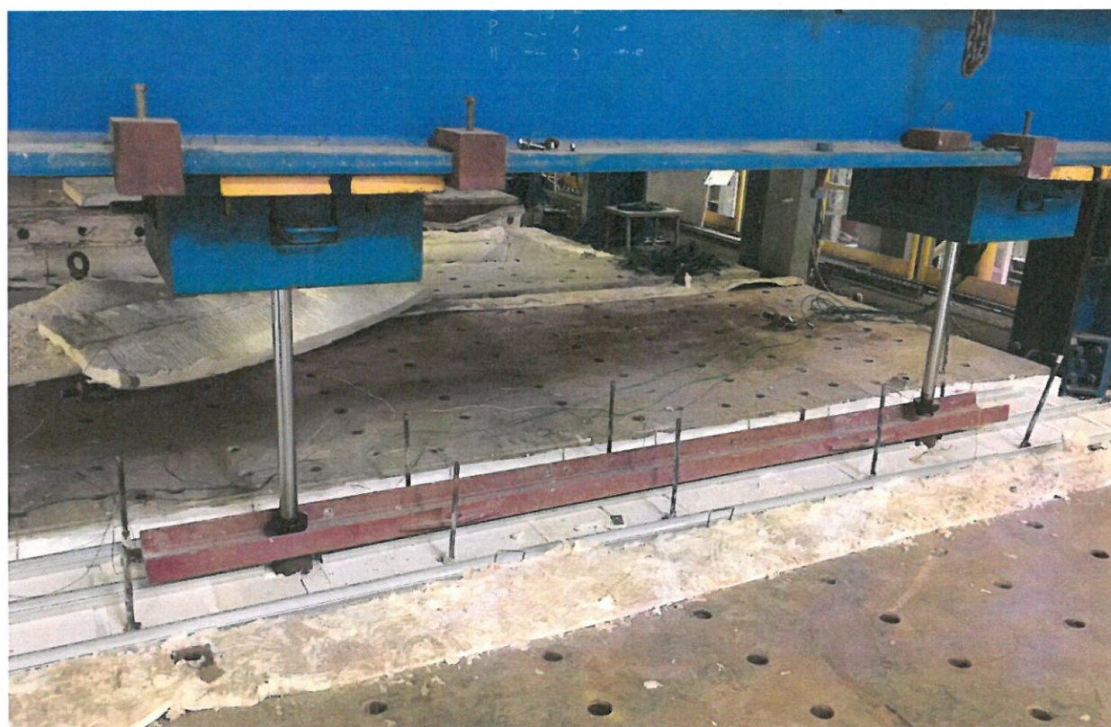
Rys. 2. Element próbny przed badaniem – strona nienagrzewana
