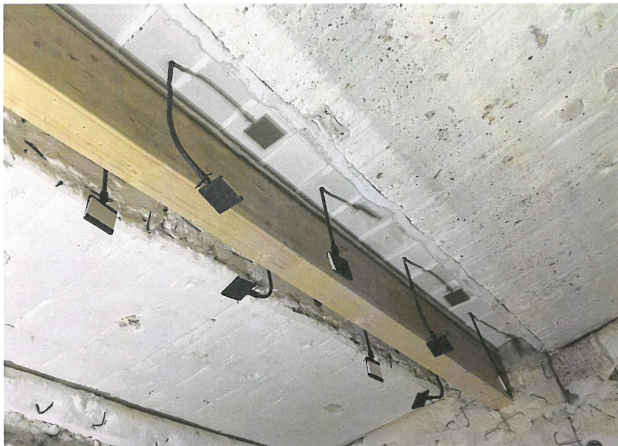
Rys. 1. Element próbny przed badaniem – strona nagrzewana
