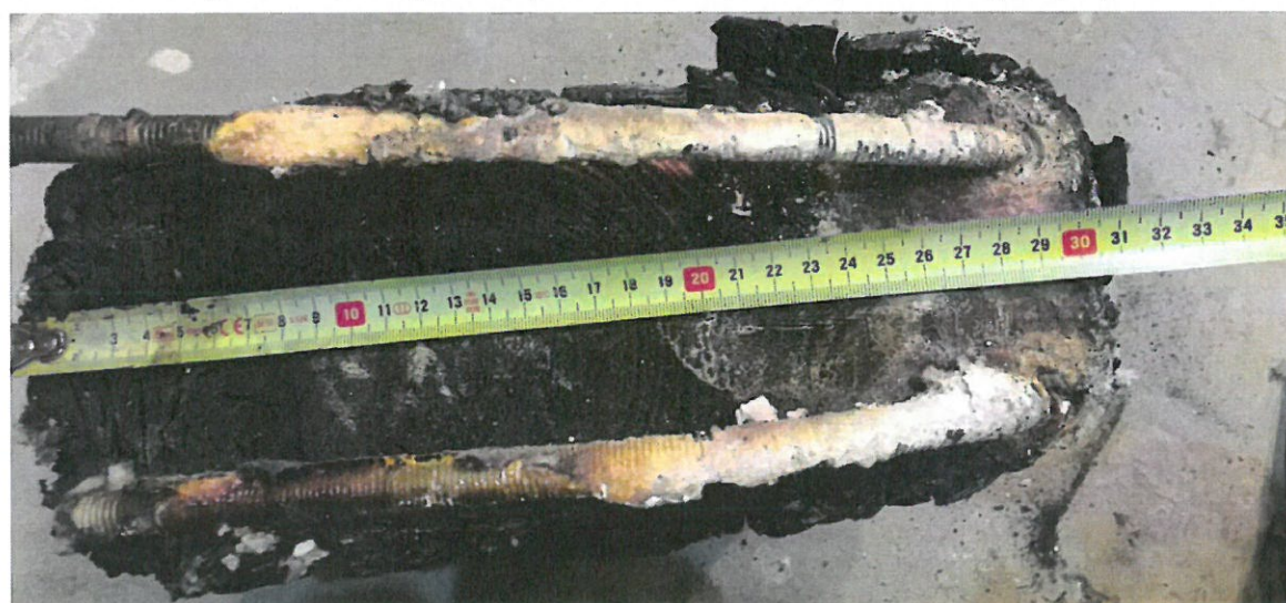
Rys. 7. Element próbny po badaniu – łączenie belek (na zdjęciu widoczne są górne pręty łączne)
